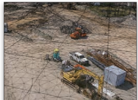
패러매타 경철도 프로젝트는 AEROMETREX에서 수행한 고해상도 ContextCapture 프로젝트로 60,000개의 이미지에서 포괄적인 현실 메시를 만들었습니다.
