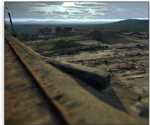
Společnost CEDARVILLE během 20 minut zachytila pomocí dronu více než 750 leteckých fotografií a pomocí aplikace ContextCapture zapracovala základní snímky pro vytvoření přesného modelu reality.
