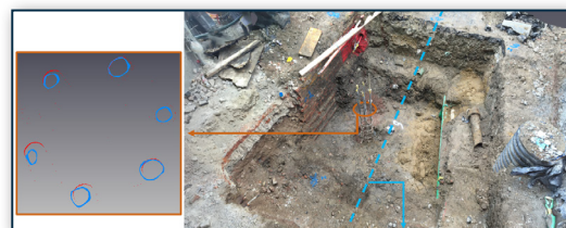
Горизонтальный разрез арматурных стержней, показывающий точное сравнение фотограмметрии с наземным лазерным сканированием (TLS): синие кружки изображают фотограмметрию, а красные кружки — TLS; максимальное отклонение составляет ~ 6-10 миллиметров.
