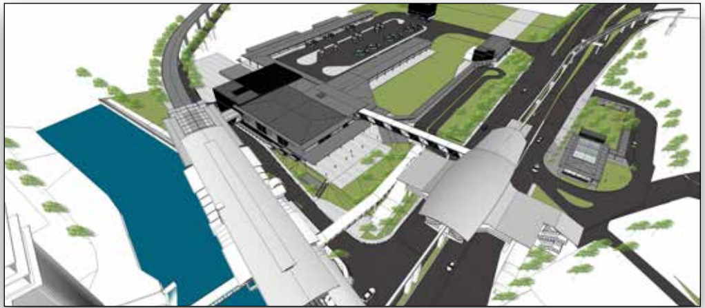
使用 ContextCapture 对现有场地条件进行三维摄影测量，有助于验证设计的精度
