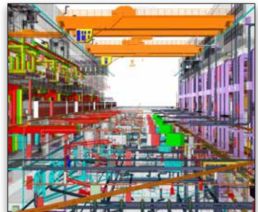
PowerChina Huadong Engineering Corporation verwendete Bentley Raceway and Cable Management für Layout, Planung des Staudammverlaufs und Materialmengenauflistung.
