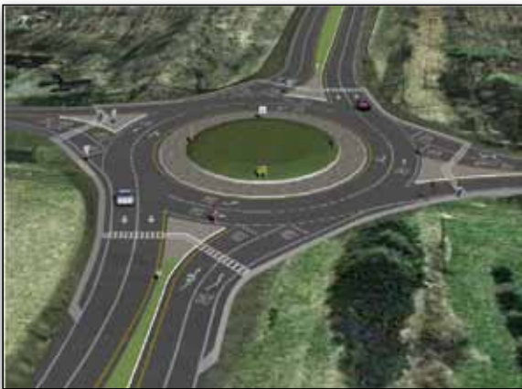
Movimento dinâmico ao longo do corredor em 3D para verificação do projeto, detecção de conflitos visuais e para a garantia da qualidade da modelagem.
