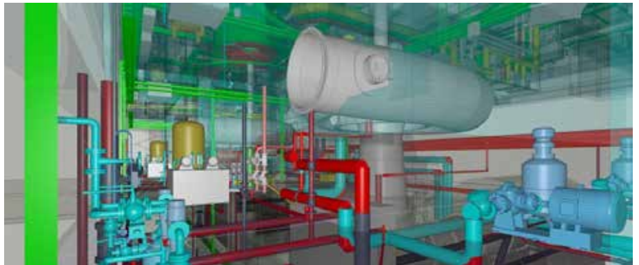
琼中抽水蓄能电站的多专业三维设计模型，由中国电建集团中南勘测设计研究院有限公司供图
